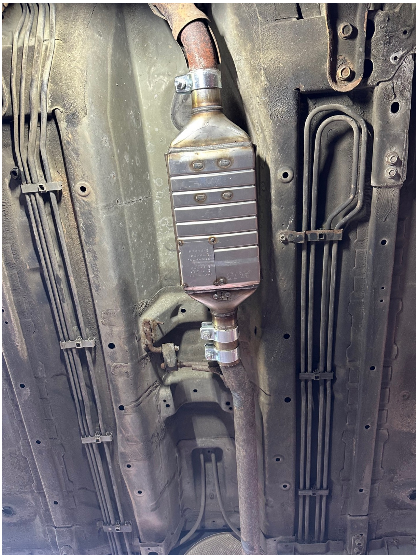
Partikelfilter DPF-09 monteret på Nissan Qashqai.
